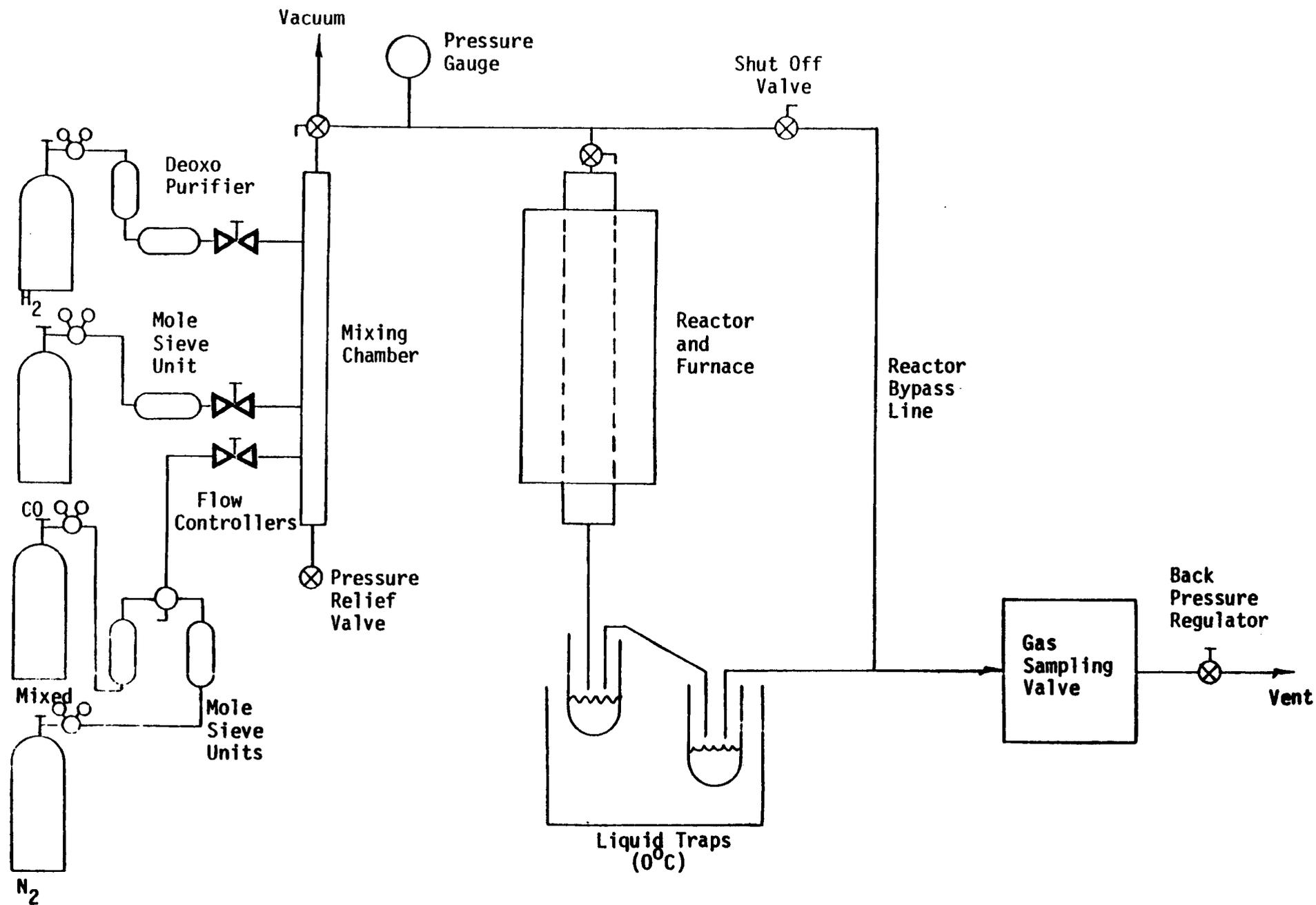
Figure 2. Fischer-Tropsch Reactor-System.
