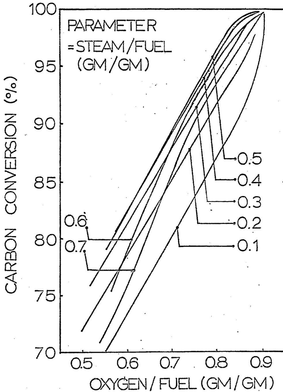
FIGURE 21. EFFECT OF OXYGEN/FUEL RATIO ON THE CARBON CONVERSION AT VARIOUS STEAM/FUEL RATIOS FEEDING THE H-COAL RESIDUE FROM ILLINOIS NO. 6 COAL IN THE TEXACO PILOT PLANT GASIFIER
