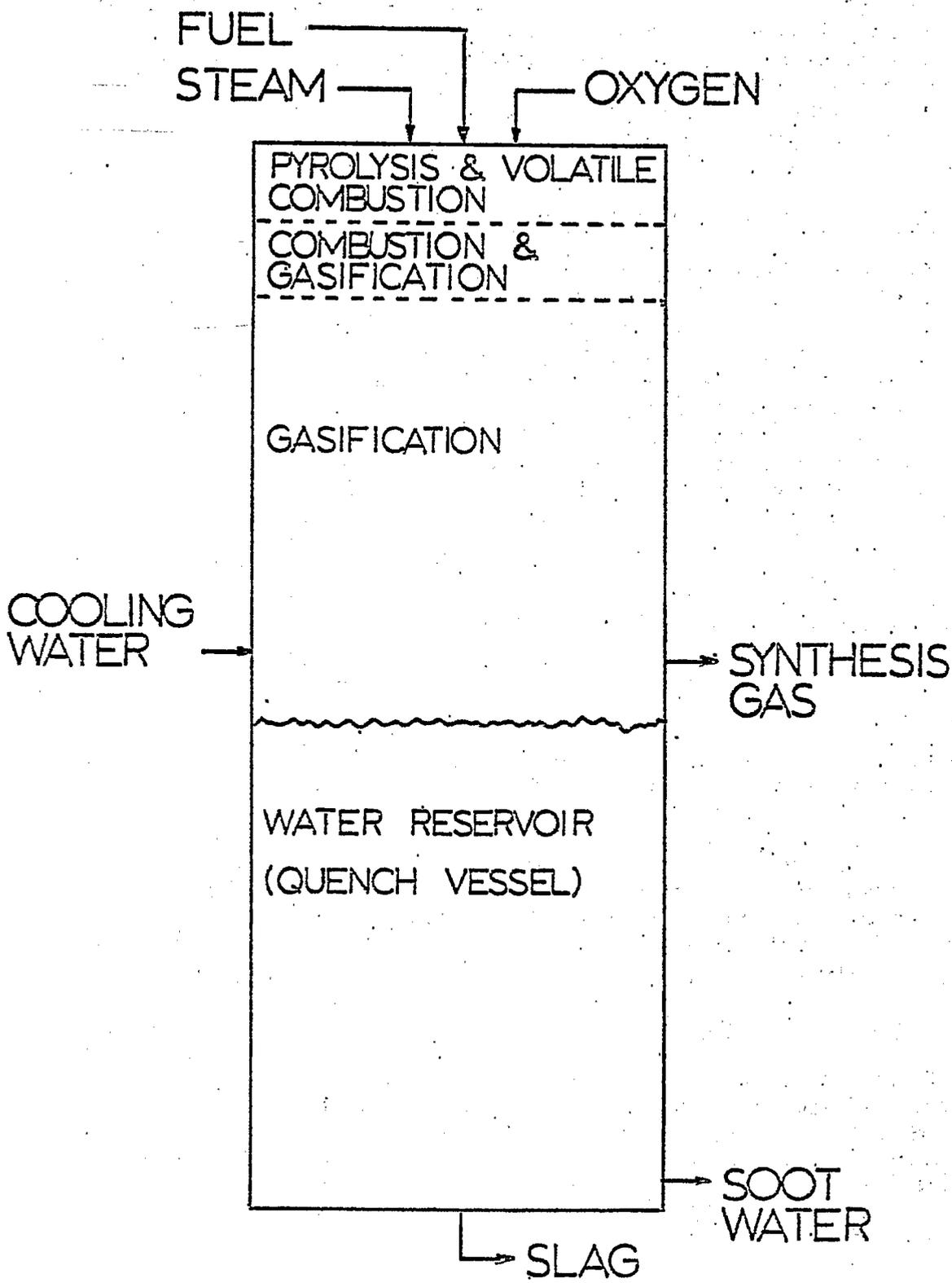
FIGURE 1. TEXACO DOWNFLOW ENTRAINED BED PILOT PLANT GASIFIER
