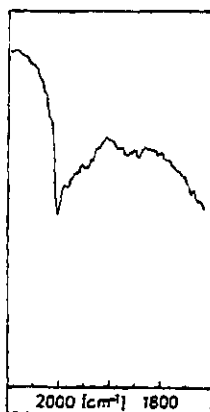
Abb. 29: Charakteristische Banden des IR-Spektrums von \text{SIL/NH}_2\text{Fe}_3(\text{CO})_{11} (KBr)
