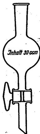
**Abb. 2a:** Scheidetrichter zur Abtrennung der wässerigen Bleilsg.
