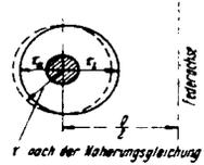
Abb. 14 Verteilung der Randschubspannungen am Umfang des Kreisquerschnittes einer Schraubenfeder
