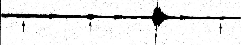
Bild 9 Klopfsvingungen am DB 6001-Einzyylinder
