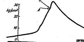
Bild 9. Druckdiagramme, klopfende Verbrennung (nach Kamm und Rickert).
