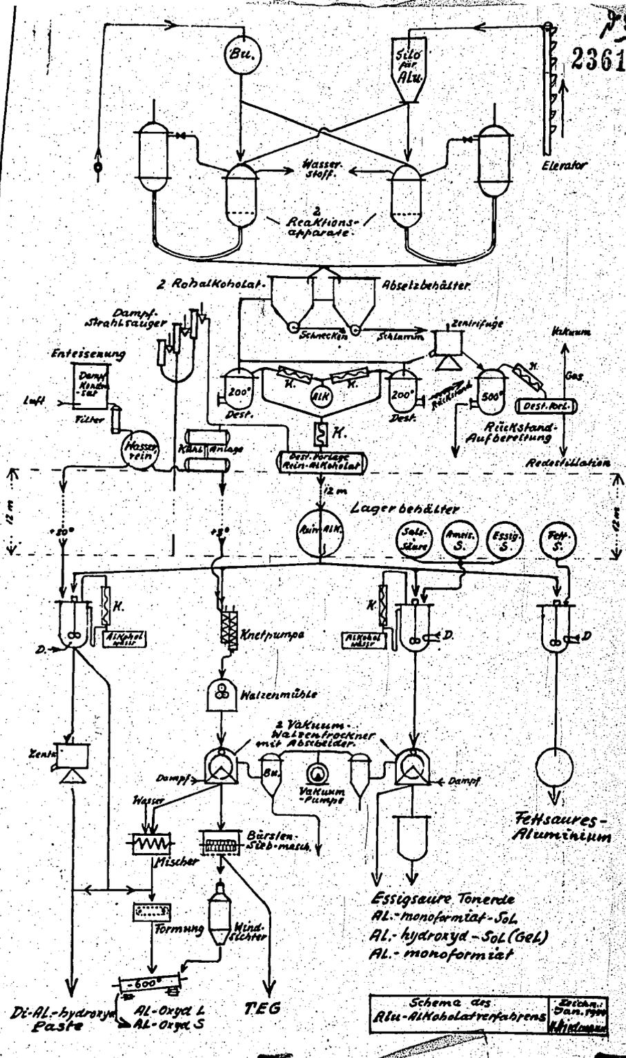
Materialbedarf zur Gewinnung und Verarbeitung von 5 to Aluminium-Alkoholat unter Einsatz von 3 to 25 - 30%iger Aluminiumlegierung pro Tag.
